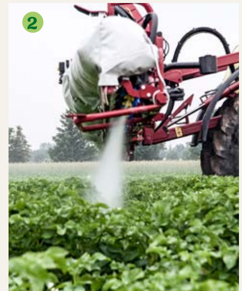
Utan luftassistans (1) och med luftassistans (2) för minskad vindavdrift, bättre täckning och därmed god behandlingseffekt.
