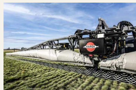
Hardi PulseSystem - Pulserande munstycken förenklar varierad dos efter styrfil. Kan kombineras med kurvkontroll där över-/underdosering minskas. Rampen på bilden är en Hardi Aeon Twin.
