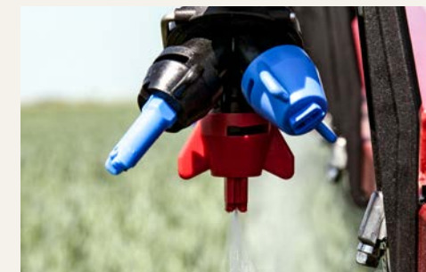
Tre olika munstycken på en tripplett där munstycken snabbt växlas manuellt på sprutrampen.
